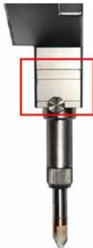
(2) Sostenga el cabezal de soldadura con la boquilla de cobre hacia abajo, tire del cajón del espejo protector del cuerpo del cabezal de soldadura, muévelo a un entorno limpio y sin polvo, y selle el cuerpo del cabezal de soldadura para evitar la entrada de polvo, como se muestra en la figura:
