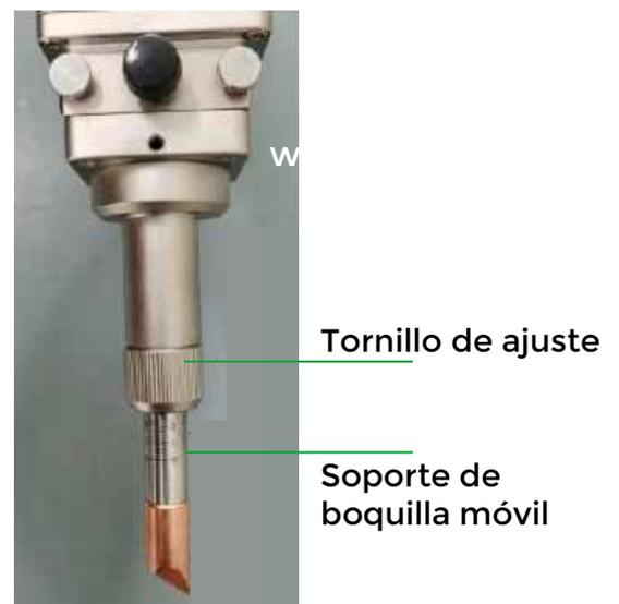
El rayo láser que sale de la boquilla de la pistola de soldadura un rayo con enfoque láser, podemos ajustar la abrazadera de la boquilla de la cabeza de la pistola para hacer que el rayo esté justo en la posición del producto de soldadura.
