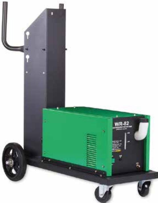
El **WR-82** es una unidad de refrigeración, muy eficiente para las torchas que refrigeradas por líquido. Esto le permite trabajar a altos amperajes en entornos de soldadura de alta producción y ciclos de trabajos prolongados.
