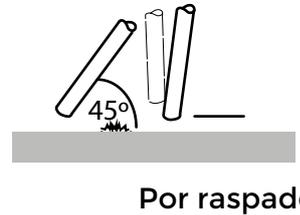
La soldadura MMA se refiere a soldadura con electrodos revestidos. El arco eléctrico funde el electrodo y el revestimiento forma una capa de protección (escoria). Si para abrir el arco, el electrodo se presiona contra la pieza a ser soldada, el electrodo se funde y adhiere en la pieza haciendo imposible la soldadura. Existen dos formas de encender el arco correctamente, por golpeteo o por raspado siendo esta última la más utilizada.
