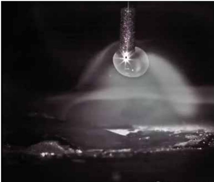
El metal fundido de aporte forma una bola de aproximadamente dos veces el diámetro del electrodo que al tocar la superficie del metal fundido se funde y transfiere a la pileta de fusión.
