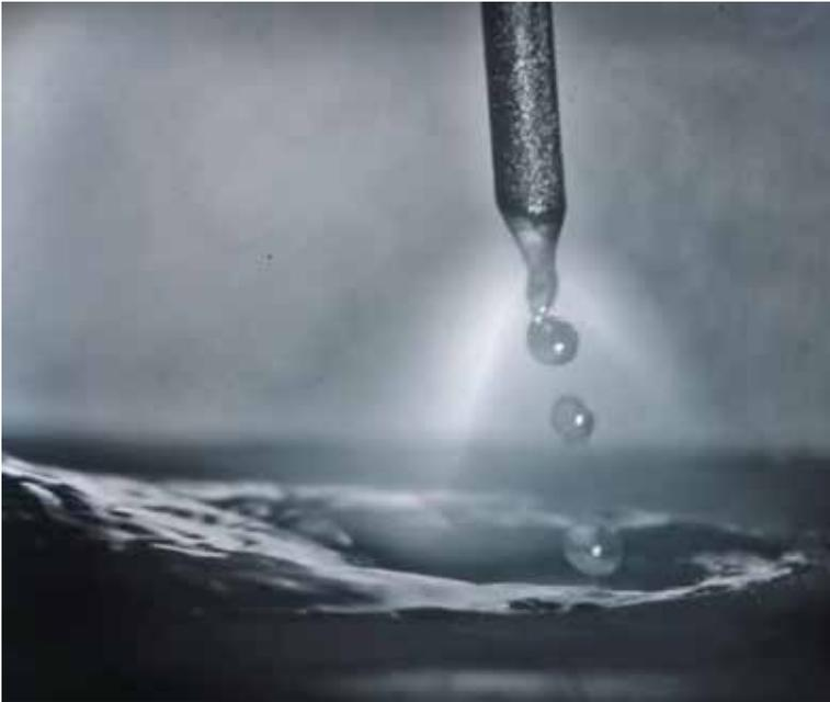
Al elevar los valores de amperaje, se sobre exige la capacidad conductora del alambre, generando la pulverización del mismo. De ahí, el nombre de este tipo de transferencia.
