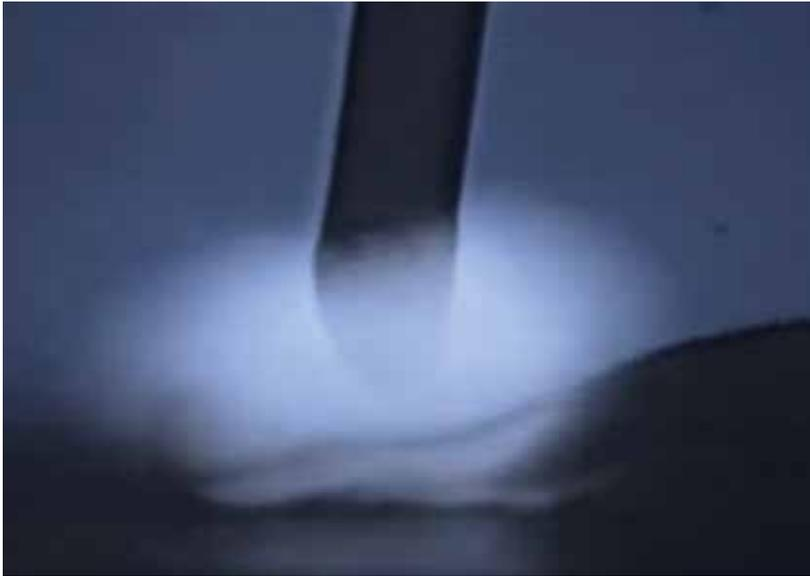
El metal se transfiere a la pieza al producirse el contacto entre el extremo del alambre y la pileta, generando un ruido constante y repetitivo
