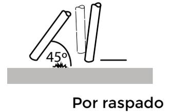
La soldadura MMA se refiere a soldadura con electrodos revestidos. El arco eléctrico funde el electrodo y el revestimiento forma una capa de protección (escoria). Si para abrir el arco, el electrodo se presiona contra la pieza a ser soldada, el electrodo se funde y adhiere en la pieza haciendo imposible la soldadura. Existen dos formas de encender el arco correctamente, por golpeteo o por raspado siendo esta última la más utilizada.
