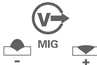
Regule de voltaje. Define La longitud del arco, T° en la pieza Penetración y ancho del cordón.
