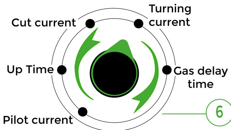
**Cut current:** Corriente de corte ( expresada en amperes).
