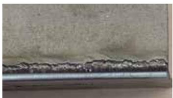
**Socavado:** Para evitar el socavado, reducir el amperaje y la velocidad de avance.
