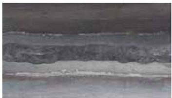
**Amperaje excesivo:** Genera un cordón de soldadura sin una forma definida. El metal se vuelve quebradizo, y se corre el riesgo de perforación.
