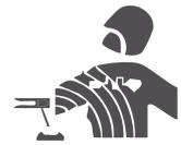
Guiar los cables auxiliares y del electrodo a la vez y utilizar cinta adhesiva siempre que sea posible.
