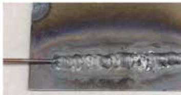
**Falta de fusión del cordón:** Ocurre cuando el diámetro del electrodo demasiado grande. Además, el diámetro de la varilla de material de aporte debe ser cercano al espesor del material base.
