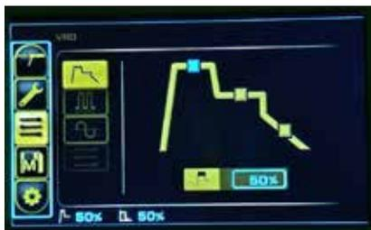
**Configuración VRD:** Es un sistema de seguridad que reduce el voltaje de la máquina cuando no está en uso para evitar electrocuciones. La función VRD baja el voltaje en circuito abierto a un nivel seguro cuando el soldador no está activamente realizando un arco de soldadura, lo que lo hace especialmente importante para procesos como la soldadura por electrodo manual revestido (MMA). En proceso MMA el VRD deberá estar encendido (ON) y TIG se recomienda apagado (OFF).
