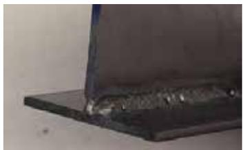
**Inclusiones:** Mantener una distancia segura entre la pieza de trabajo y la torcha ayudará a evitar la inclusión de tungsteno, donde el tungsteno en realidad se funde en el baño de soldadura.
