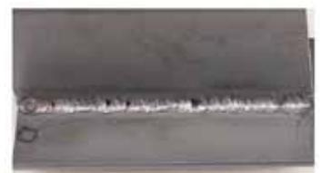
**Porosidad:** Esto ocurre cuando la suciedad o el aceite en el material base se vaporiza y forma un bolsa de gas en el baño de soldadura, o por un caudal de gas escaso.
