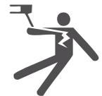
Aislar la pieza de trabajo y el suelo con un aislante seco. Asegurarse de que el aislante sea lo suficientemente amplio como para cubrir toda la zona de contacto físico con la pieza y el suelo.
