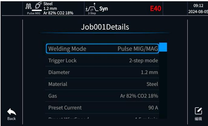
Fig. 4-5-6.2 Detalles de guardado del TRABAJO
