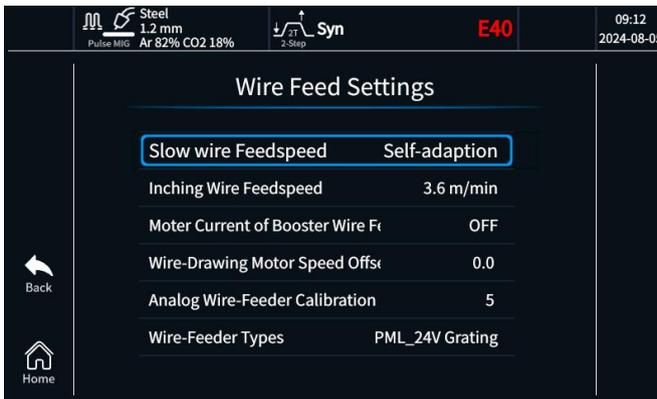
Fig. 4-4-6.2 Parámetros del submenú - Ajustes de alimentación de alambre
