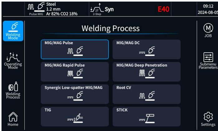
Fig. 4-5-3 Selección del modo de soldadura del menú
