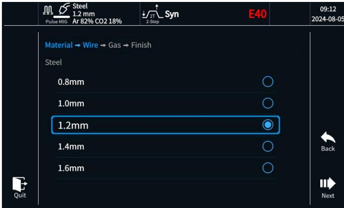
Fig. 4-5-5.3 Ajustes del proceso de soldadura - Alambre
