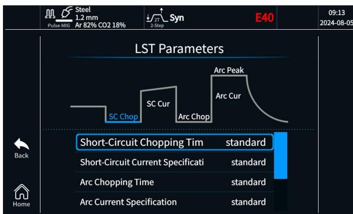
Fig. 4-4-6.6 Parámetros del submenú - Parámetros LST
