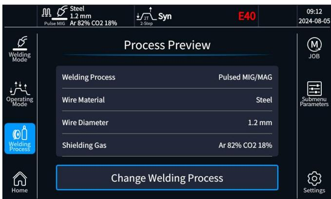
Fig. 4-5-5.1 Menú - Ajustes del proceso de soldadura
