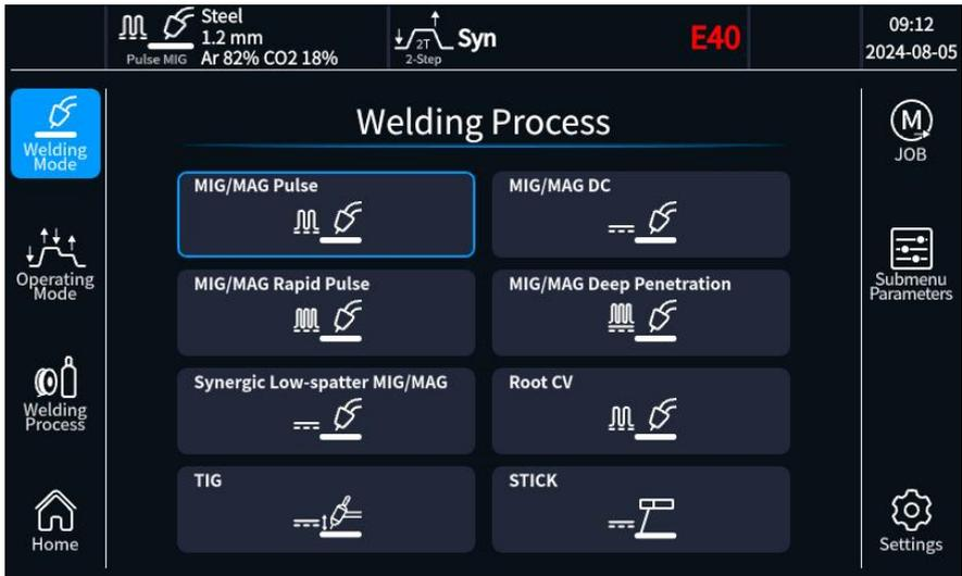
Fig. 4-4-4 Menú - modo de soldadura
